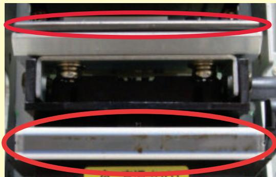
↑ クリーニング頻度が少ないので汚れが付着しています。通常のクリーニング動作だけでは落ちにくく、下記ヘッドアップクリーニングのステップへお進み下さい。
